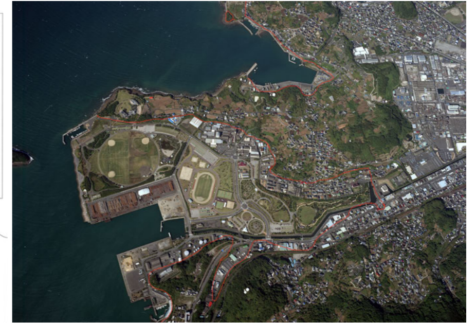
上図 赤線がもとの海岸線 左図 黒枠の中が海底の泥の浚渫(すくい上げること)を行った区域
